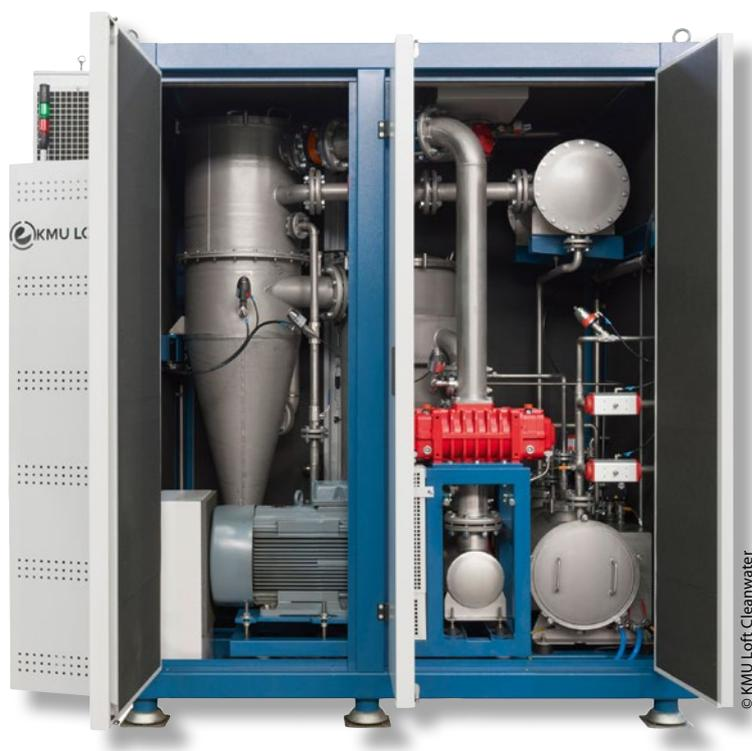
Durch die modulare Bauweise lässt sich die neue Verdampferanlage flexibel an unterschiedliche Prozesswässer anpassen.
